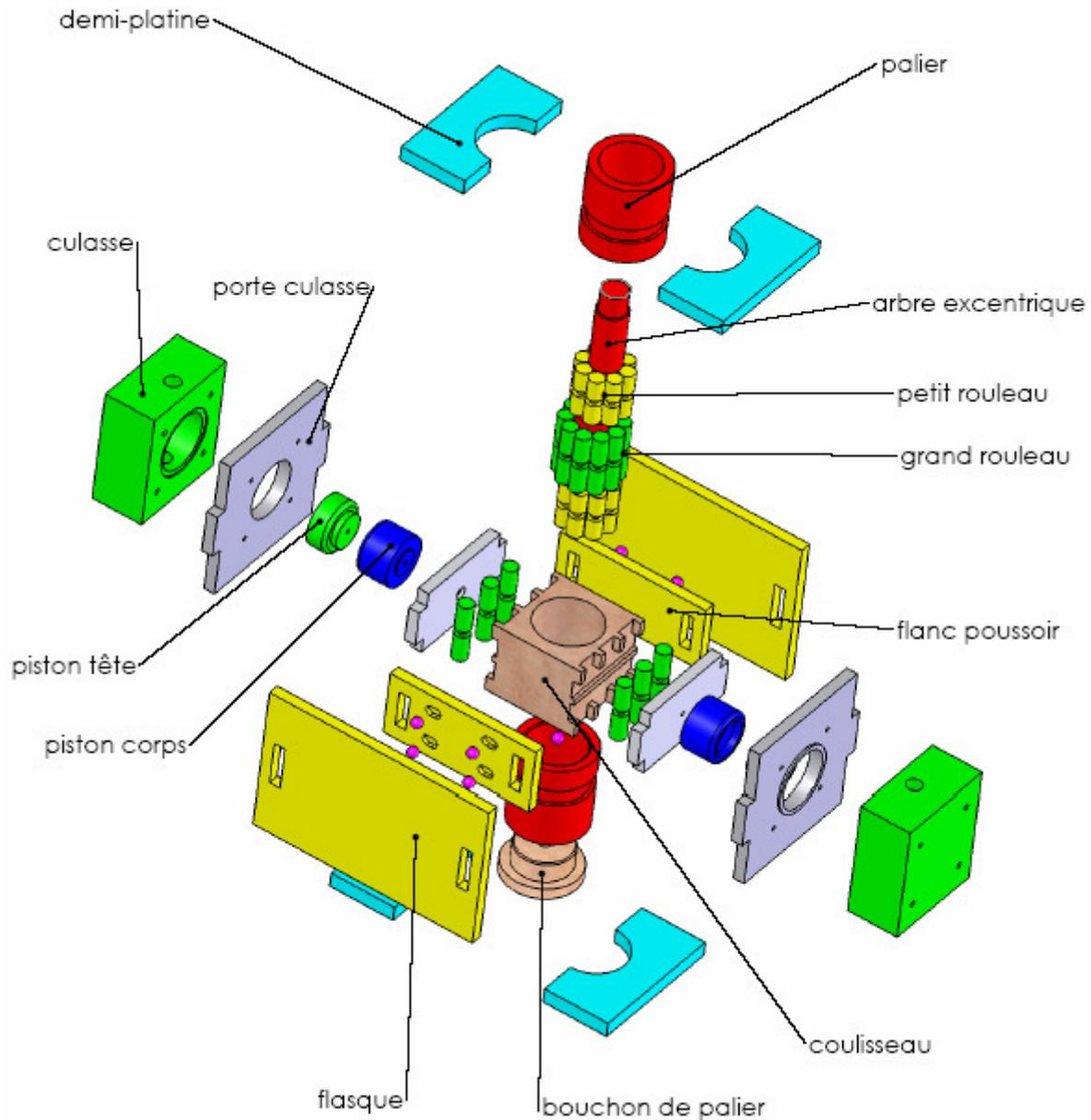
L'arbre est mu par l'éolienne et sa partie excentrée (entourée de rouleaux pour limiter les frottements) pivote à l'intérieur du coulisseau qui va translater et pousser les pistons latéraux dans un mouvement alternatif gauche droite.
